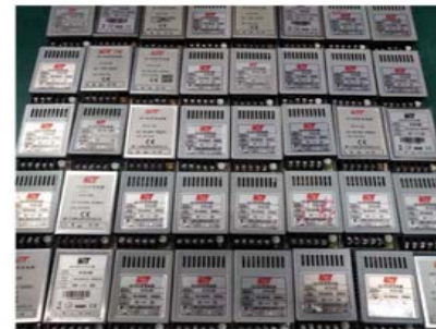
更换了进口电容的5V开关电源
